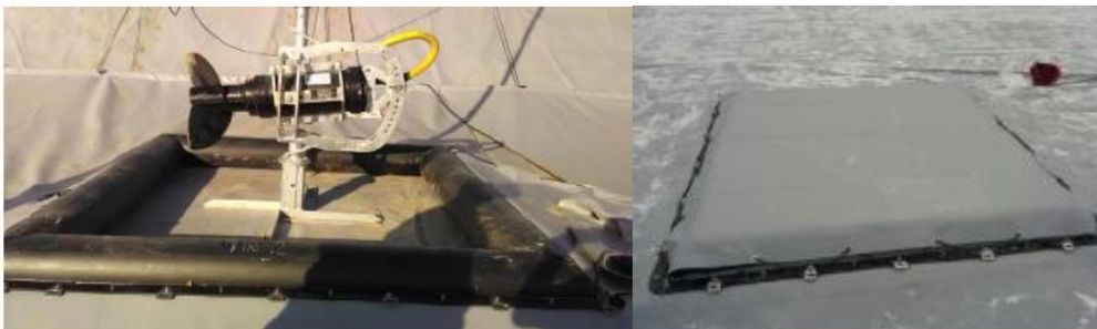
Figure 16 : Exemple de poche de stockage (Source : Biogas Plus)
