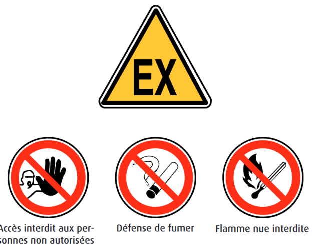
Figure 31 : Signalisation des zones ATEX et affichage de sécurité (Source : INERIS)
