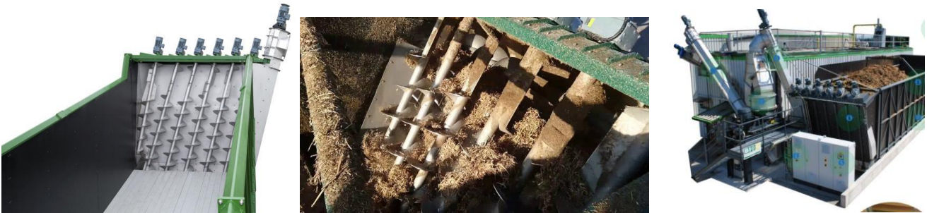
Figure 15 : Technologie d'incorporation des matières solides (Source : Biogas Plus)
